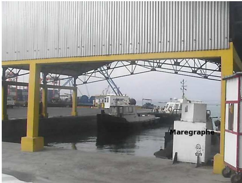
FIG. 2 – Le marégraphe à flotteur se trouve dans la caisse blanche faisant face à un bassin du Port Autonome de Djibouti.
