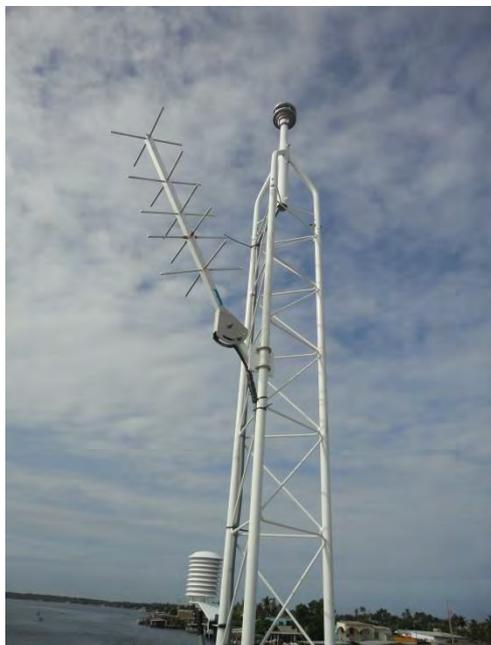
**TORRE METÁLICA CON SENSOR DE VIENTO SENSOR DE TEMPERATURA Y HUMEDAD RELATIVA Y ANTENA DE TRANSMISIÓN SATELITAL GOES**
